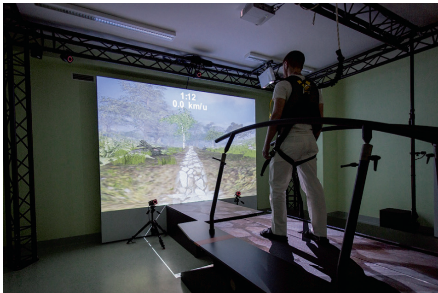
Joonis 3. Kõnnitreeningu ja -analüüsi interaktiivne süsteem GRAIL.
